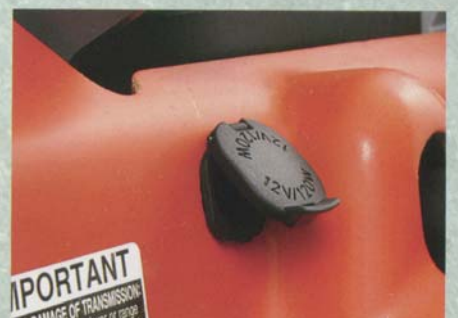
TOMA DE CORRIENTE
